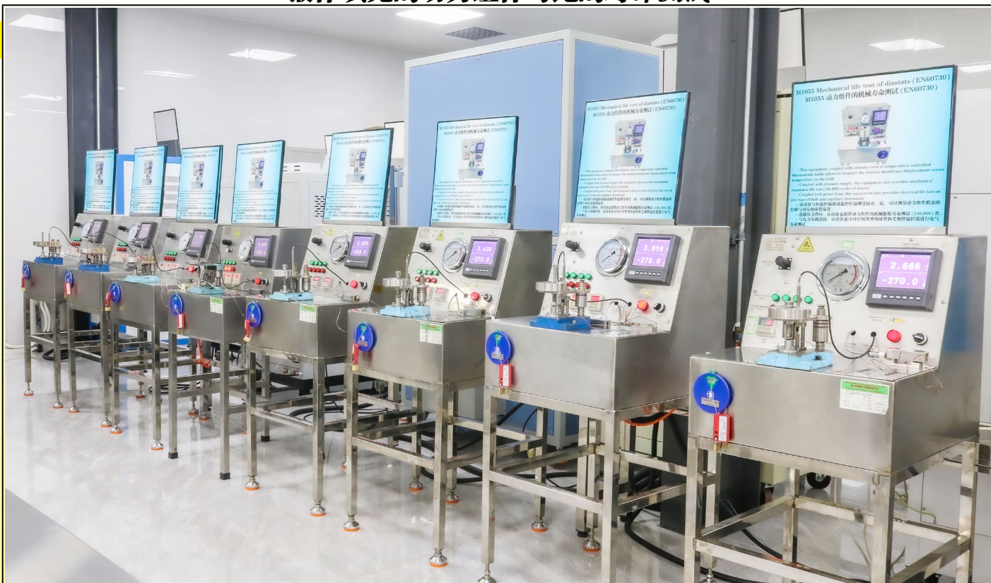
整套的动力组件机械寿命测试自动化设备。每台设备均配有测试参数和循环次数的数据记录仪。(Ultimheat实验室)
